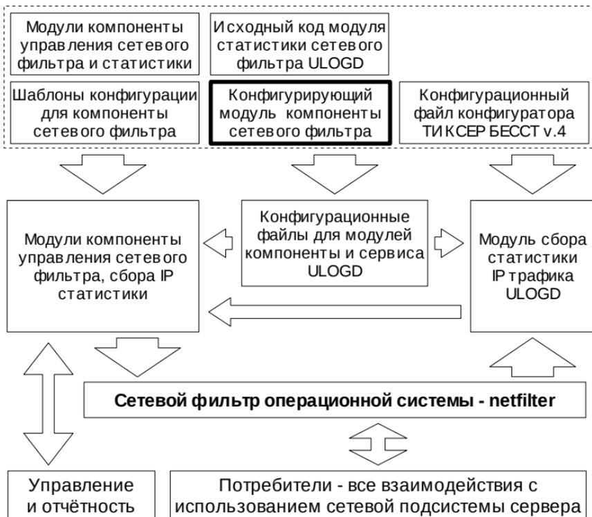
В процессе первоначальной подготовки типового коммуникационного сервера специальный модуль конфигулятора формирует конфигурационный файл компоненты методом модификации шаблонов конфигурации, входящих в поставку ТИКСЕР БЕССТ v.4.0, значениями, рассчитываемыми на основе данных конфигурационного файла конфигулятора (конфигурации внутренней и внешней IP подсетей, а также имени обслуживаемого домена)
