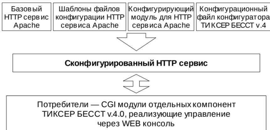
Конфигурационный файл базового сервиса Apache формируется на основе шаблонов конфигурации, входящих в поставку ТИКСЕР БЕССТ v.4.0 отдельным модулем конфигуриатора ТИКСЕР БЕССТ v.4.0. Сформированный конфигурационный файл размещается по пути `/etc/httpd/httpd.conf` и, при наличии должной квалификации, может модифицироваться техническим специалистом под конкретные нужды. Для типового функционирования никакой ручной модификации не требуется
