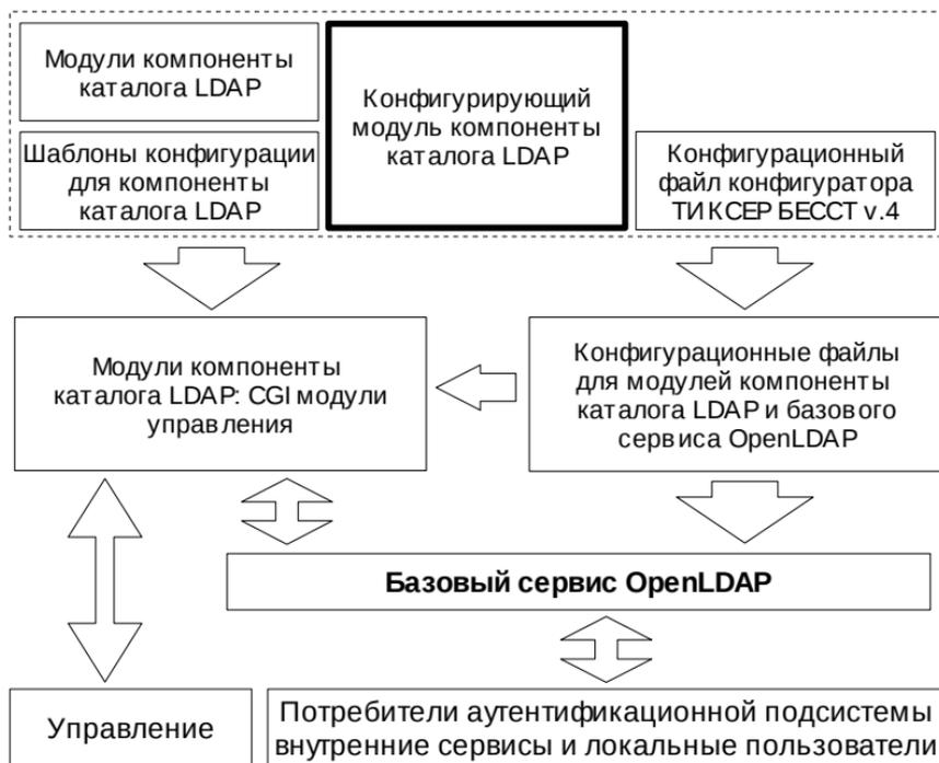
В качестве базового используется распространённый LDAP сервер OpenLDAP и клиентские модули `ram_ldap` и `nss_ldap`, входящие в дистрибутив CentOS 5.3. Конфигурационные файлы базового сервиса и модулей программных надстроек компоненты формируются отдельным конфигурационным модулем методом модификации входящих в поставку ТИКСЕР БЕССТ v.4.0 конфигурационных шаблонов
